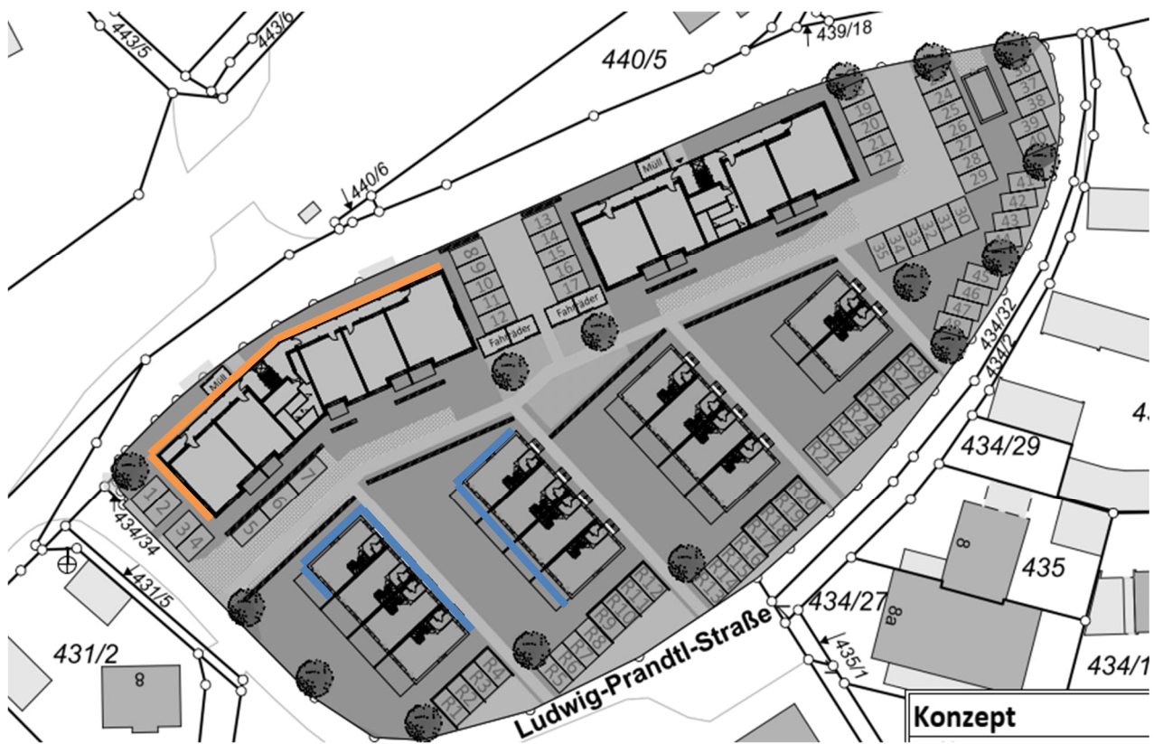
Abbildung 6: Übersicht der höchsten Pegel und möglichen Pegelreduktion infolge der Lärmschutzmaßnahme (Lärmschutzwand) im Plangebiet
