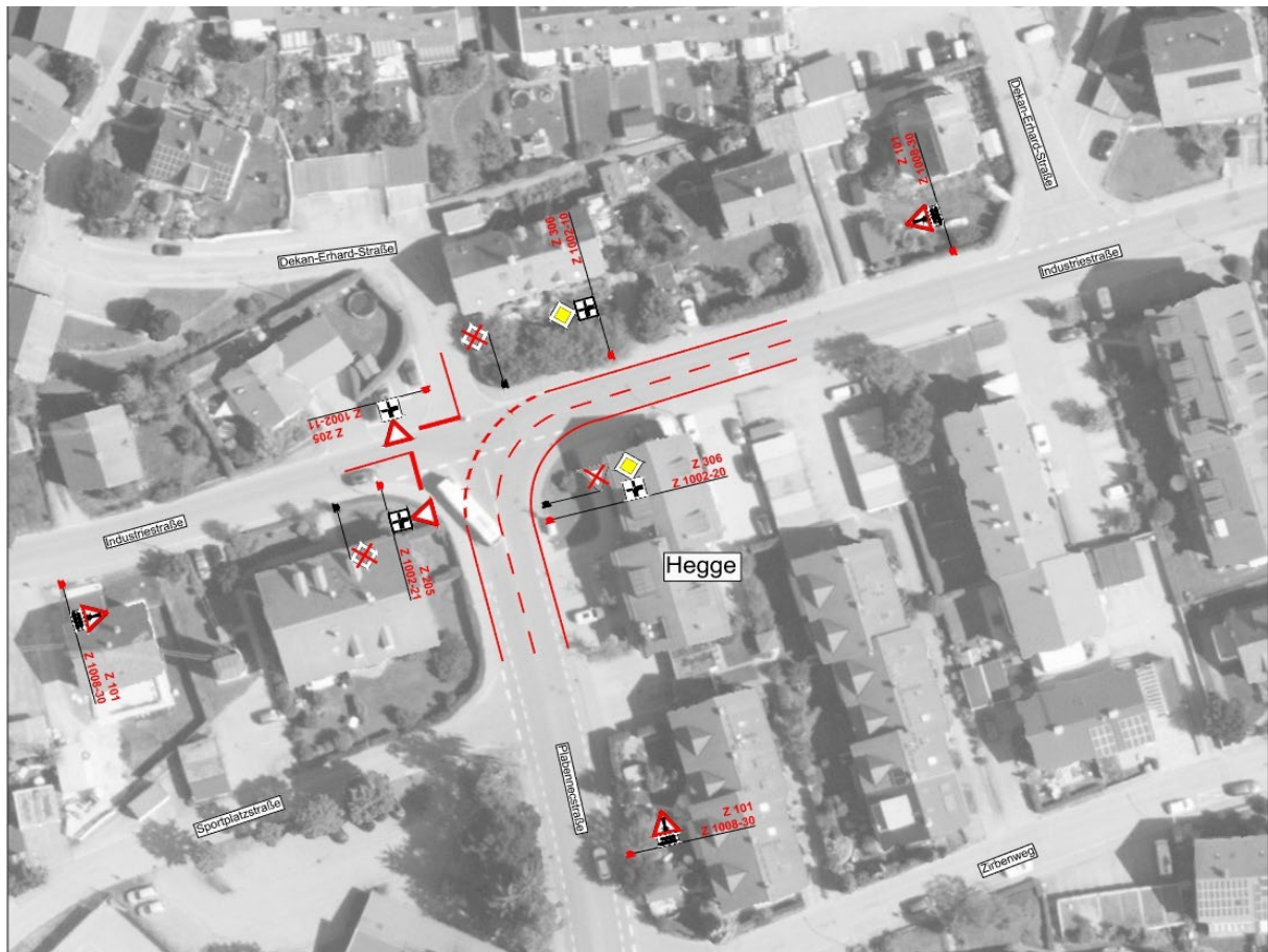
B 19 Bauabschnitt Nord Vorfahrtsänderung Industrie-/Plabennecstraße Hegge ab 15.06.2026
