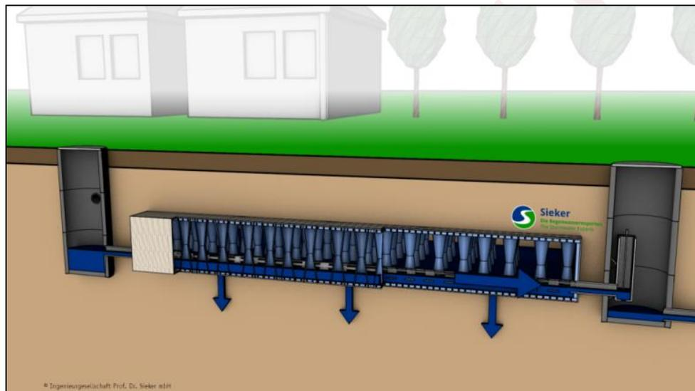
Abbildung 7: Prinzipskizze einer Rigole (ungedichtet) [Quelle: Sieker]
