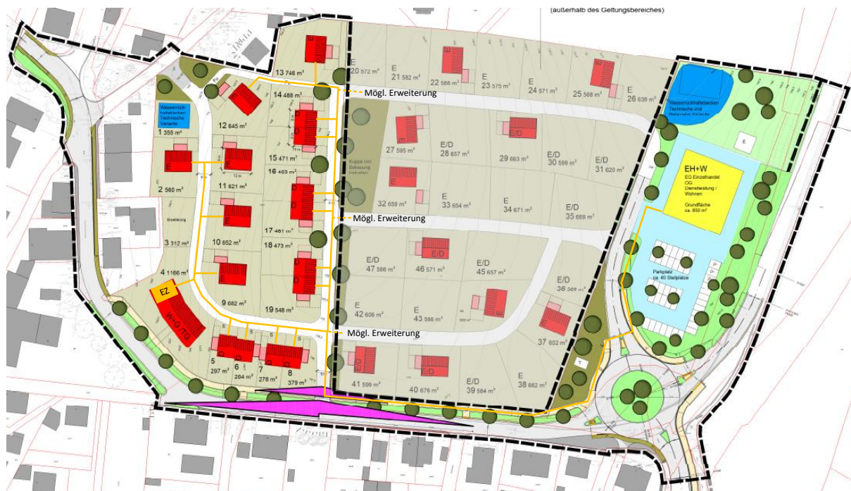
Abbildung 27: Wärmeverteilnetz Variante 1a BHKW
